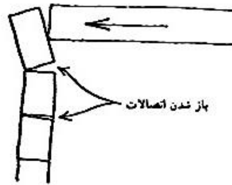
شکل ۹ مصالح با ضریب انبساط متفاوت سازه‌ی بنا را تغییر می دهد.
