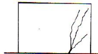
روند ترک‌ها در دیوار بدون وزن با بار وزن (ترک‌ها بر اثر نشست پی ایجاد شده)
